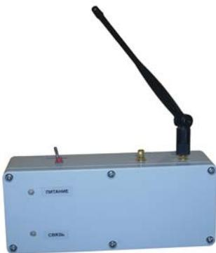
**Оперативный контроль в полностью автоматическом режиме всего процесса динамометрирования, передача данных исследований удаленному пользователю по сетям сотовой связи с помощью GSM-модема и интерактивный режим интерпретации исследований**
