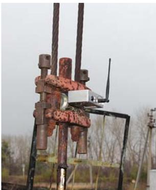
Основой стационарного динамографа «СИДДОС-автомат» с GSM-телеметрией является стационарный автономный беспроводной межтраверсный датчик серии «ДДИ»
