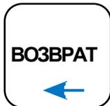
1. Кнопка обеспечивает изменение направления действия кнопок РЕЖИМ и ВВОД-ВЫВОД. Кнопка ВОЗВРАТ значительно упрощает процедуры выбора нужного числа при установке номера куста, скважины и других параметров, а также позволяет исправить ошибочное нажатие кнопок. Возврат производится одновременным нажатием кнопки ВОЗВРАТ и кнопки, которой необходим откат назад.
