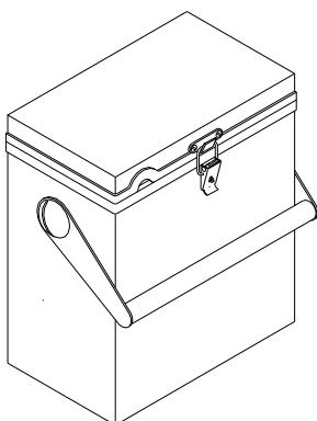
Внешний дополнительный аккумулятор БА-1 предназначен для питания уровнемера. БА-1 предназначен для работы при сильных морозах в зимних условиях, когда требуется непрерывная работа уровнемера (КВУ, КВД, вывод на режим) до нескольких суток или недель. БА-1 имеет в своем составе кислотный необслуживаемый аккумулятор с системой ограничения выходного тока, помещенного в ударопрочный металлический корпус.
