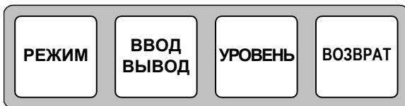
Четырехкнопочная клавиатура обеспечивает ввод (изменение) необходимых параметров, ввод команд оператора, управление всеми режимами, как автономной работы прибора, так и его "общения" с внешними устройствами. Общий вид, расположение и обозначения кнопок клавиатуры показаны на рисунке.
