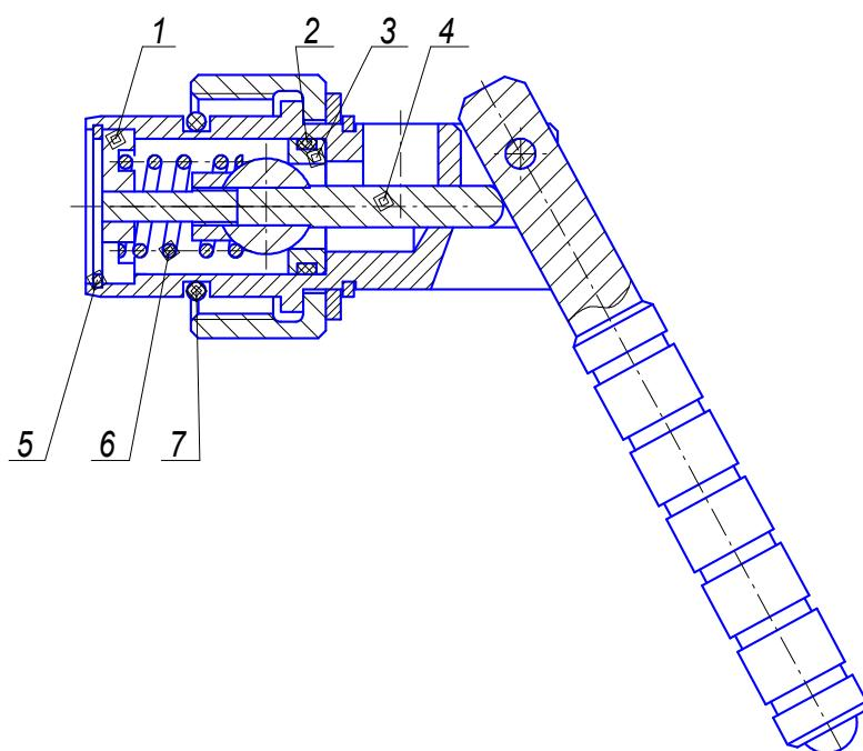
клапанную пару (толкатель с шариком (4) и седло (3)). Для этого осторожно сожмите стопорное кольцо (5) и выведите его из корпуса клапана. Выньте из корпуса направляющую втулку (1), пружину (6) и толкатель с шариком (4). Выньте из корпуса седло (3) с уплотняющим кольцом (2).
