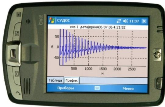
Блок визуального контроля БВК-хх предназначен для визуального отображения результатов измерений в табличной и графической форме, уточненного определения уровня по графикам эхосигналов, записи этих данных в свою память и последующую передачу их в компьютерную базу. При этом сохраняется возможность накопления результатов исследования в самом уровнемере, а также последующей их передачи в компьютер.
