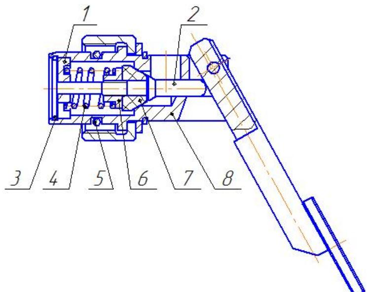
поверхность уплотнительного резинового кольца (5) нанесите небольшое количество смазки ЦИАТИМ ГОСТ 6267-80. После установки клапана на уровнемер смонтируйте последний на Стенде контроля уровнемеров СКУ-1 ИЗМ 4.137.003 (компания «СИАМ») и при давлении 5...8 атм. продуйте клапан чистым
