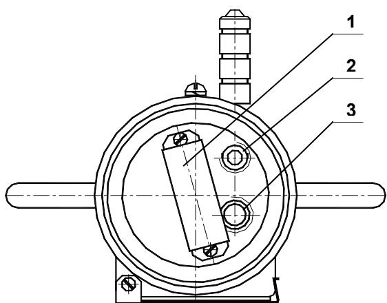
Категорически запрещается использование металлического инструмента при очистке акустического датчика и датчика давления, кроме того, при их очистке, не прикладывайте больших усилий. Корпус акустического датчика покрыт защитным лаком, не повредите его! Нельзя вводить в отверстие датчика давления посторонние предметы!
