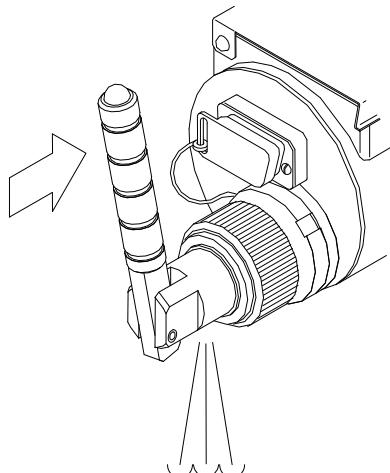
измеряет уровень шума в скважине и автоматически определяет необходимый порог срабатывания. Разряд индикатора, в котором появляется символ, зависит от уровня шума: чем выше уровень шума, тем правее символ. Сгенерируйте акустический импульс, кратковременно нажав до упора рукоятку ручного клапана уровнемера.
